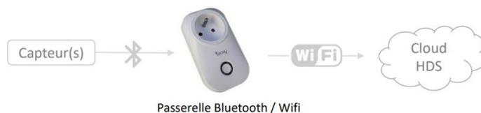
Les capteurs sont les dispositifs servant d'appareils de collecte à la solution de télésurveillance TUCKY CENTER.
